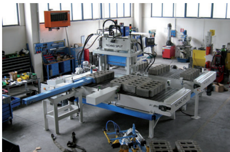
Die Spaltanlage in Dubai besteht aus einer Spaltmaschine mit einer Spaltlänge von 800 mm, einer Spalthöhe von 280 mm und einer Spaltkraft von 80 t.
