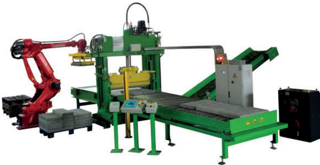
Techno Split Spaltanlage mit einem Comau-Roboter
