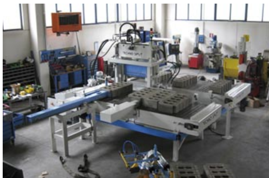
W skład instalacji w Dubaju wchodzi łuparka o długości rozłupywania 800 mm, wysokości 280 mm i sile czynnej 80 ton.
