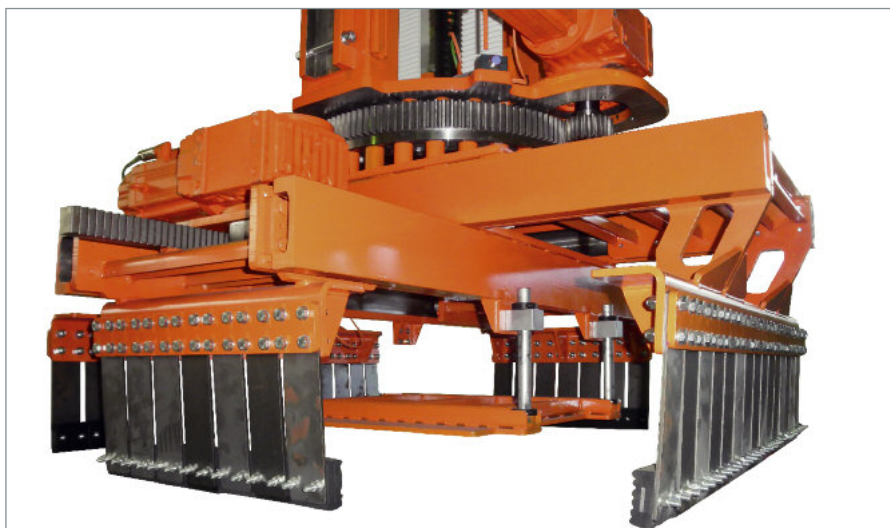
Nowa linia do łupania wyposażona jest w automatyczne szczypce zamykane elektrycznie.
