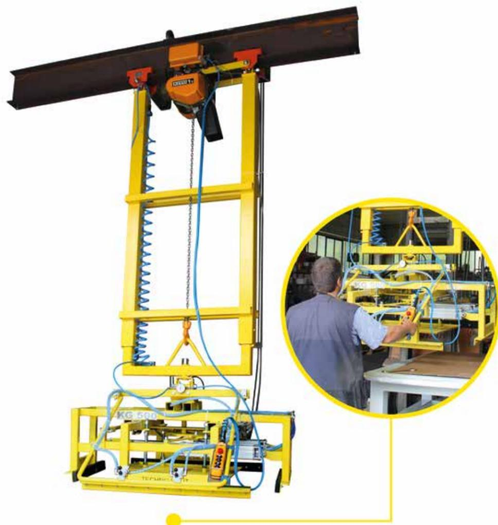
Pinza verticale idonea a scorrere su monorotaia, viene usata principalmente per caricare e scaricare le nostre linee di splittaggio, ma è adatta anche per la manipolazione di altri manufatti tipo pavé. La capacità di sollevamento varia da 500 a 1000 kg mentre l'apertura minima e massima è personalizzabile secondo richieste del cliente.
