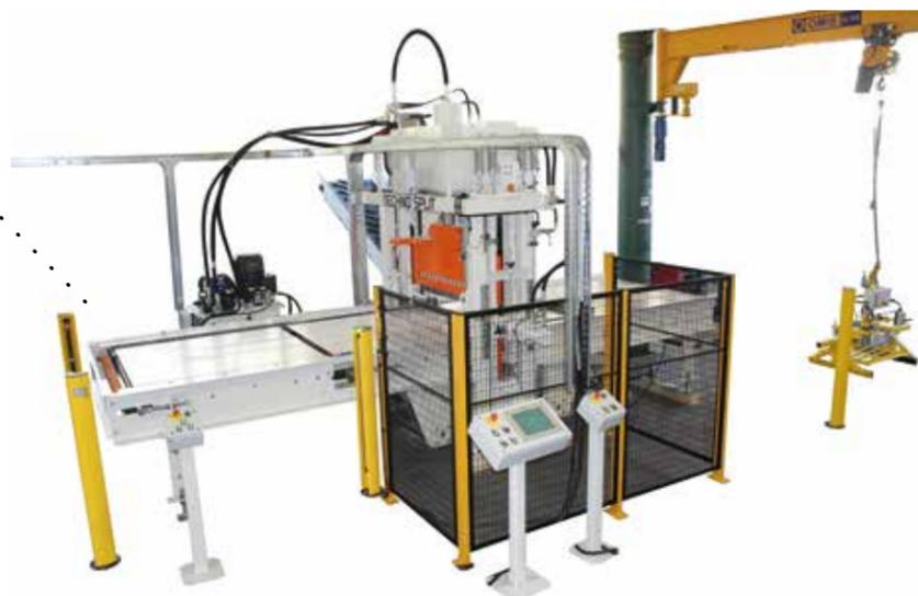
La linea di splittaggio è dotata di un banco in entrata indipendente dal ciclo automatico di splittatura poiché deve consentire il carico dei blocchi senza l'interruzione del ciclo di lavorazione. La linea può essere caricata e scaricata con l'ausilio di due gru a bandiera. La linea è in grado di evacuare gli scarti tecnici in modo automatico.
