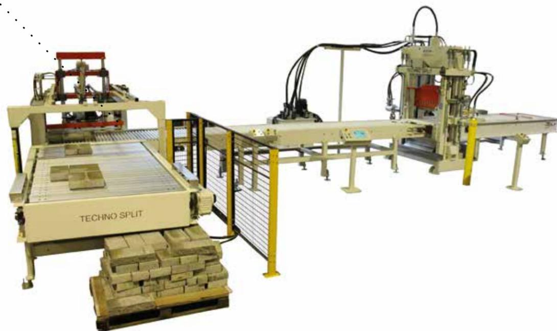
**Impianto di splittaggio con area per il controllo qualità effettuato manualmente da un operatore addetto. Il posizionamento dei blocchi sul trasportatore in uscita avviene tramite spintore. Le operazioni di carico e scarico, avvengono tramite pinze verticali di produzione Techno Split.**
